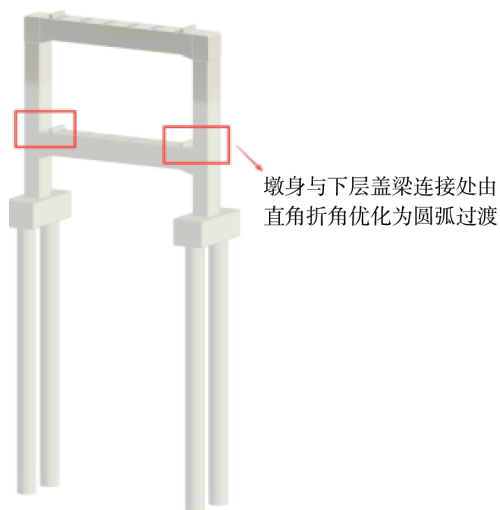
图13 桥墩 BIM 模型
