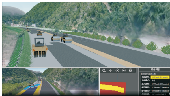
图2 智能摊铺碾压数据监控系统
