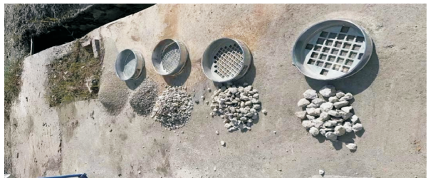
图5 室内筛分试验
