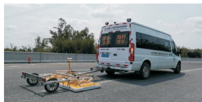
图3 介电常数现场检测图
