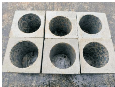
图 1 取芯后标准混凝土试件
