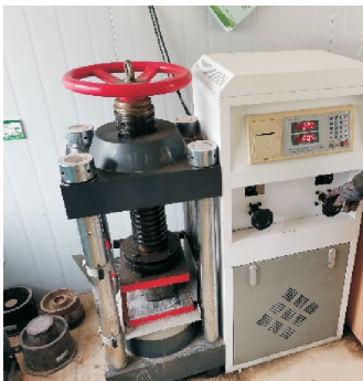
图 6 无侧限抗压强度测试过程
