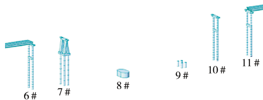
图3 应急拆除阶段拆除末态示意
