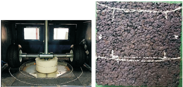
图1 室内磨耗试验 图2 试件测试区域范围
